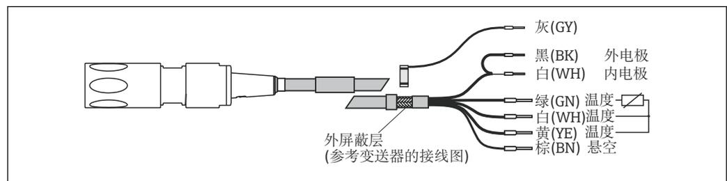
图 4 测量电缆 CPK9
